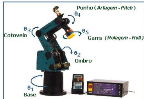
Figura 38 - Robô manipulador SCORBOT-ER4PC (Zwirtes, 2004)
